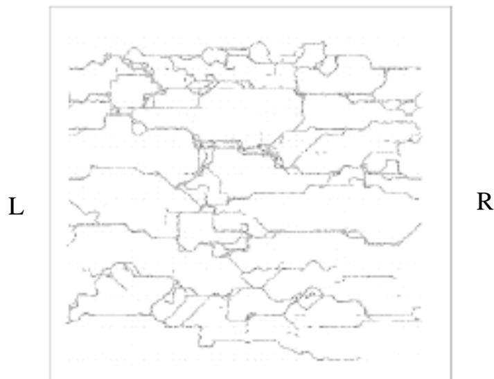
Fig.3.10 Per potenziali non molto superiori a quello di soglia, in un sistema 2D, sono favoriti molti canali per la conduzione della corrente attraverso il sistema.[26]
